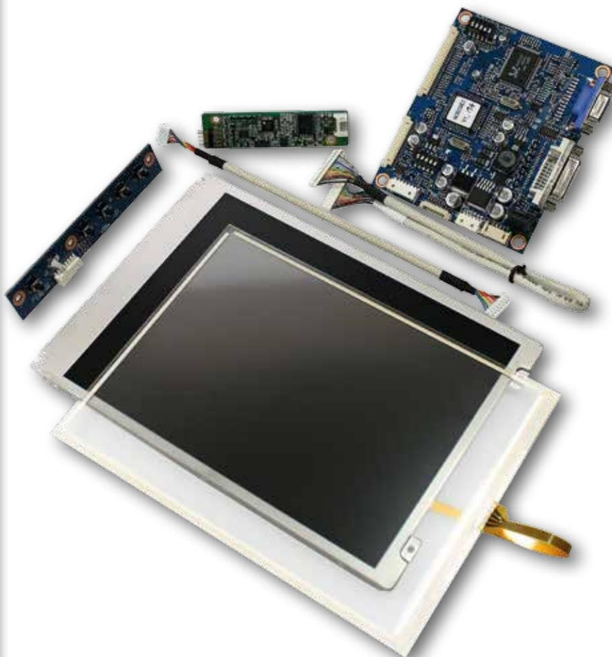
**Geprüfter Touch-Display-Kit in resistiver Ausführung**
