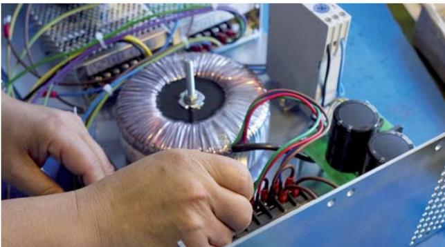
Oben: das frühere Stromeinspeisungs-Gerät mit mehreren Netzteilen, mit einem Ringkerntransformator und grossen Aluminium-Elektrolyt-Kondensatoren. Diese wurden vorteilhaft durch eine einzelne Altrac-Lösung des Herstellers ARTESYN EMBEDDED TECHNOLOGIES ersetzt (unten).
