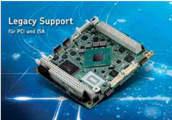
Nachfolger: Das Intel Bay-Trail-Board Advantech PCM-3365 folgt auf das abgekündigte PCM-3362 – und bietet ebenfalls volle ISA- und PCI-Unterstützung.
