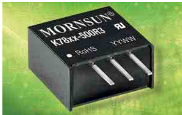
Bild 2: Aktueller Vertreter der kompakten Gleichspannungswandler K78 R3 von Mornsun
