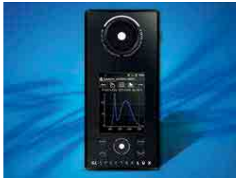
GL SPECTROLUX. Kostengünstiges Lichtmessinstrument für Beleuchtungsstärke und Lichtfarbe
