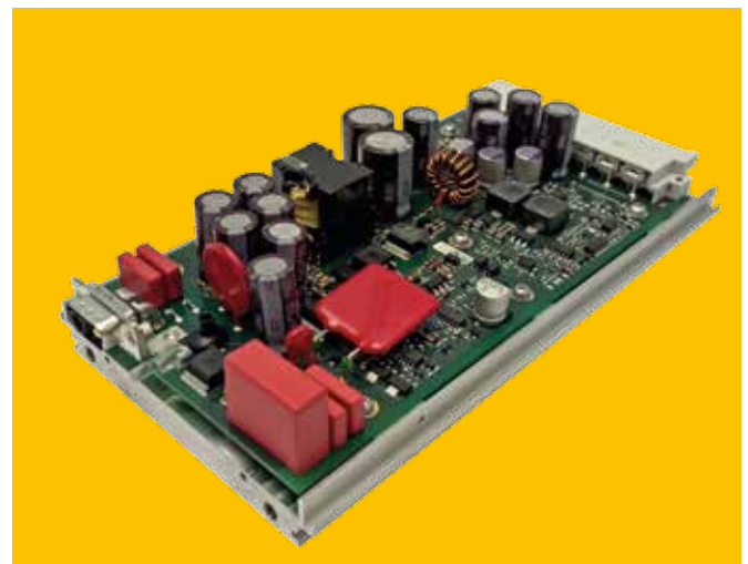
Bild: Kundenspezifischer DC/DC-Wandler mit ultraweitem Eingang von 14,4 bis 154V
