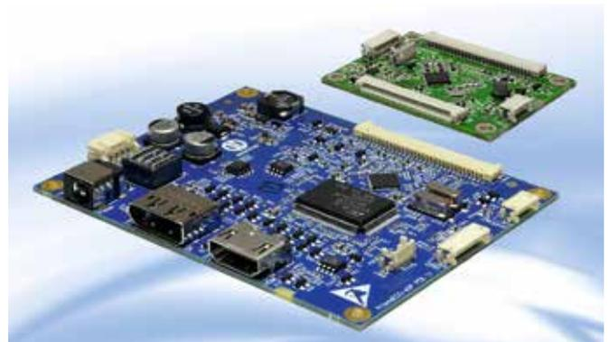
*Distec sorgt mit dem PrismaECO-eDP-Controllerboard und LVDS2eDP-Interface für ein bequemes Ansteuern von TFT-Displays mit eDP-Schnittstelle*
