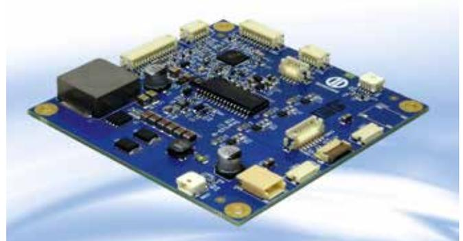
*SmartLED von Distec ist ein universeller, konfigurierbarer LED-Konverter für unterschiedliche TFT-Displays*
