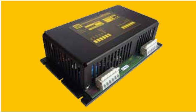
Bild 2: ACR350 DC/DC-Wandler für die Wandmontage mit 350W Ausgangsleistung
